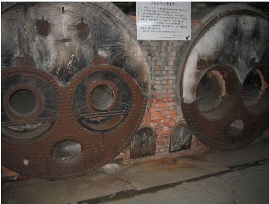
ランカシャーボイラー 希少価値が高い旧式ボイラー。昭和30年代に足利で30台程度が残っていた。
