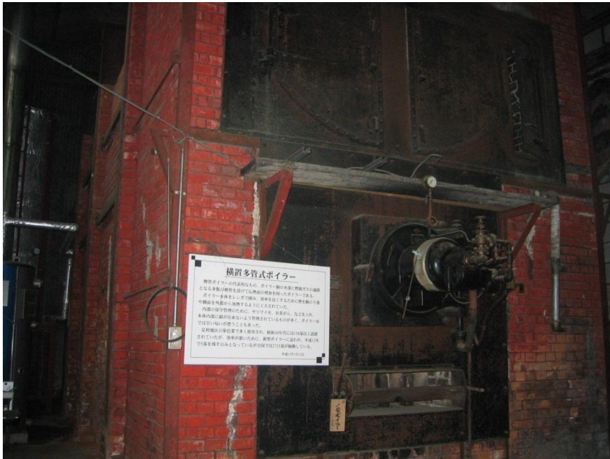
横置多管式ボイラー 煙管ボイラーの代表的なもの。ランカシャーボイラーの次代を担った。
