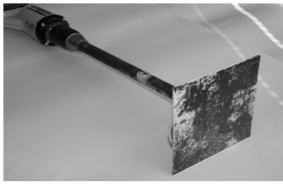
写真1 バイブロタンパー
